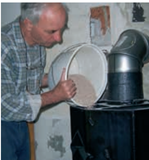
Het vullen van de Thermobox met Magnetherm-granulaat
